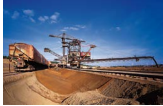
Restlochschließung mit einem Absetzer, 2001
