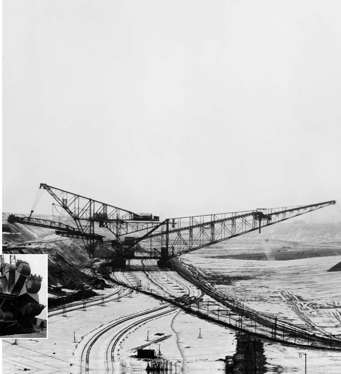
Abraumförderbrücke Nr. 13 „Meurostolln“ mit Schaufelrad kurz nach Inbetriebnahme im Tagebau VI Stadtfeld, 1942
