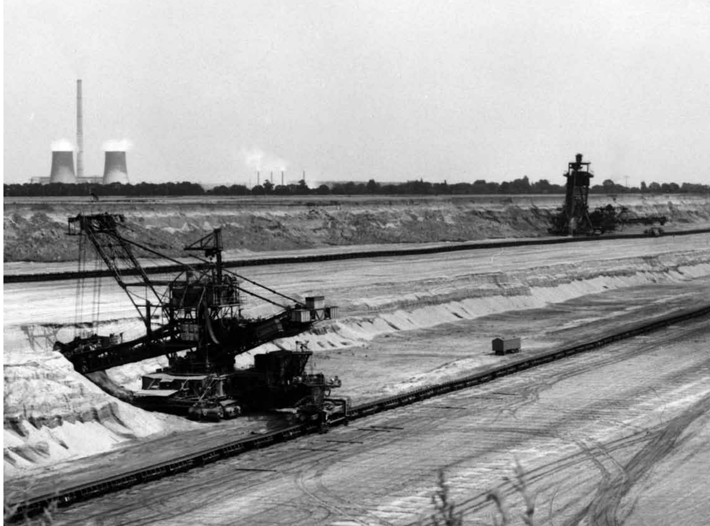
Schaufelradbagger im Abraumbetrieb im Tagebau Peres, 1985
