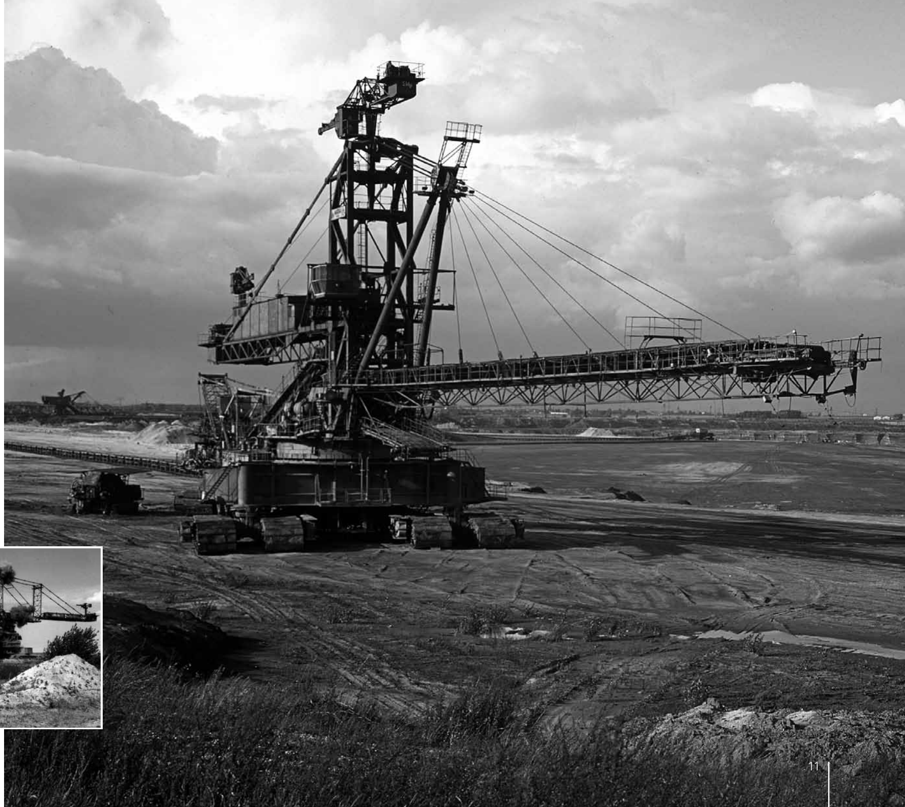
Absetzer A_Rs-B 5000-1066 auf der Kippe des stillgelegten Tagebaus Peres; im Hintergrund (l.) der Eimerkettenbagger ERs 560-328, 1991
