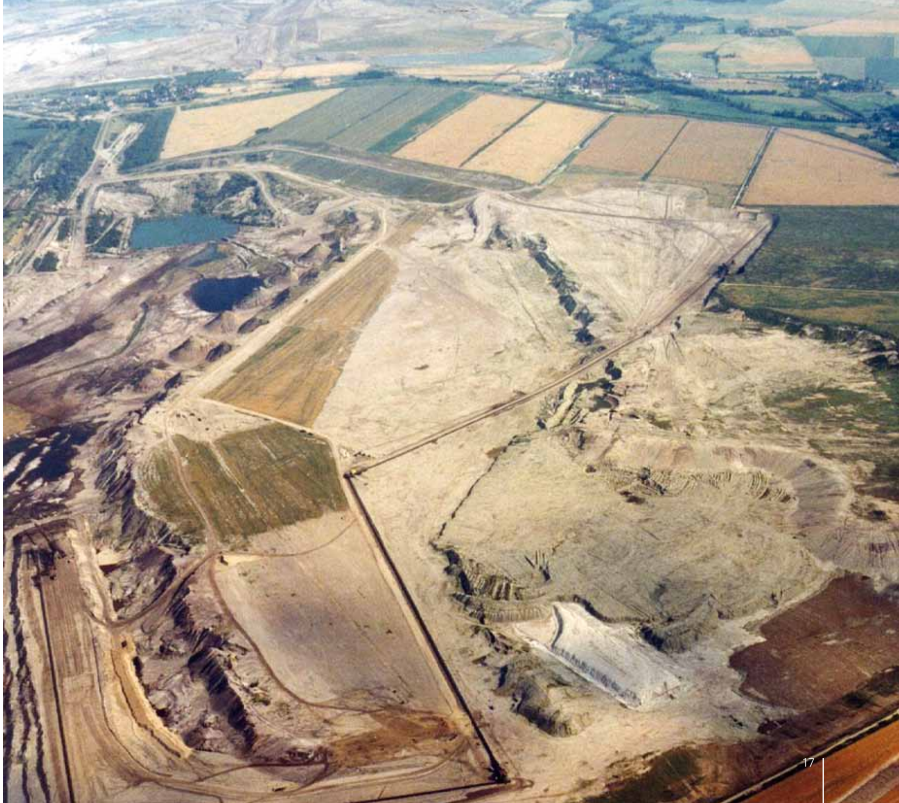
Rückgewinnung von Kippenmassen (oben rechts) zur Herstellung des Stützdammes mit dem Absetzer 1077 (links unten), 1997
